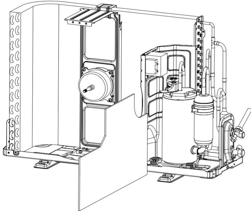
Paso 7: Desmontar la placa separada.
