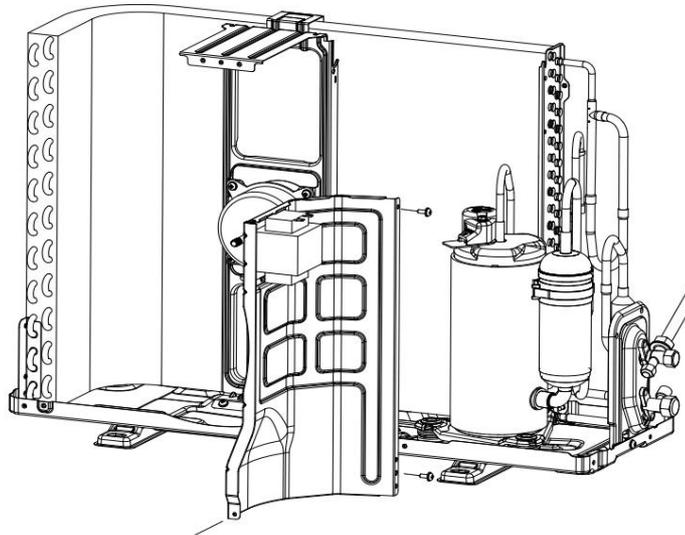
Paso 8: Desmonte la válvula de 2 y 3 vías.
