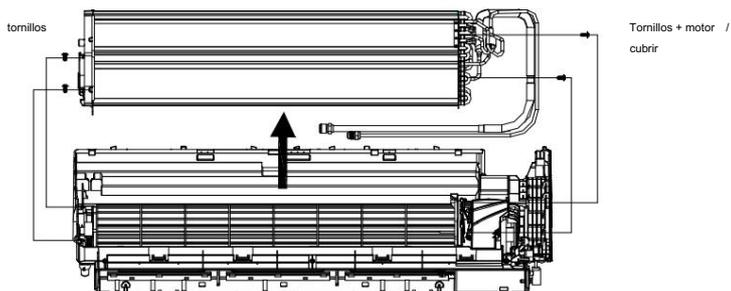
10. Retire la CUBIERTA DEL MOTOR
