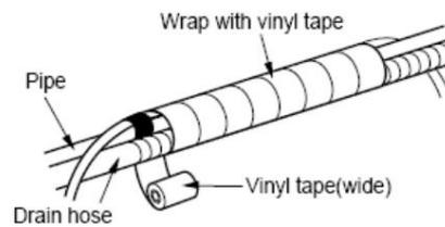
Ate la tubería y la manguera de drenaje envolviéndolas con cinta de vinilo sobre el rango dentro del cual encajan en la sección trasera de la carcasa de la tubería.
