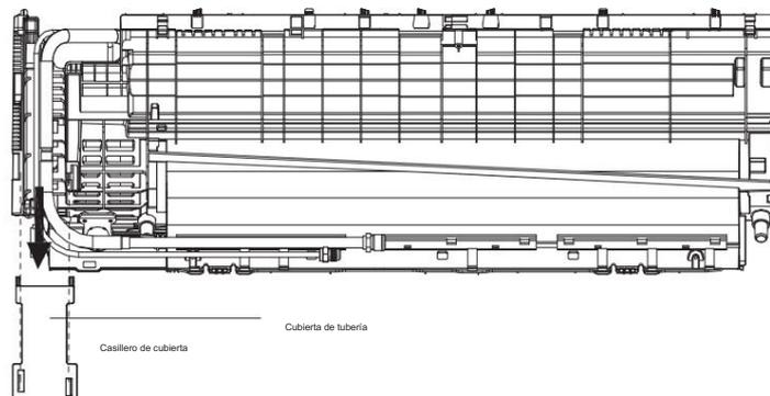
9. Desmontaje del evaporador.
