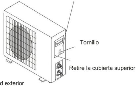
Conectando la tubería
