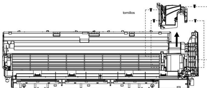
11. Desmontaje del motor del ventilador y de las aspas del ventilador.
