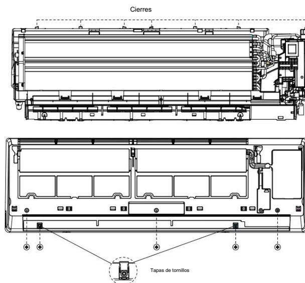
7. Desmontar la caja de control eléctrico.
