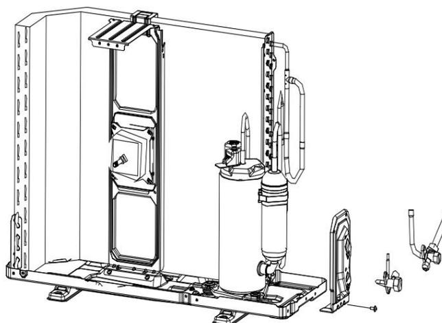
Paso 9: Desmonte el conjunto del tubo de escape y del tubo de retorno de aire.
