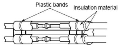
Envuelva el área que aloja la sección trasera de la carcasa de la tubería con cinta de vinilo.
