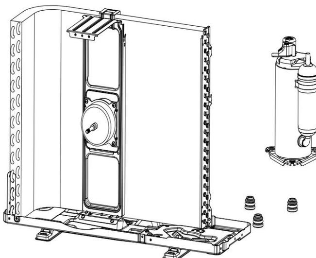
Paso 11: Retire el motor del ventilador y el soporte del ventilador.
